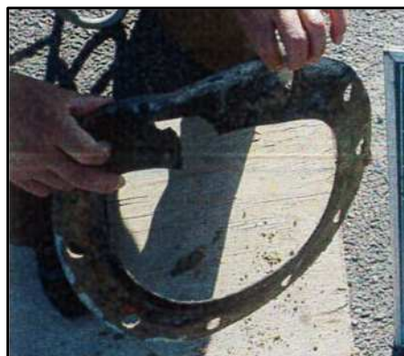
原因: 仕切弁パッキンの亀裂
