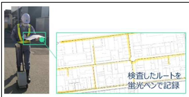
カートタイプの検知器による調査
