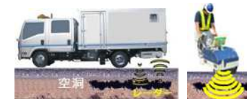
路面下空洞調査
