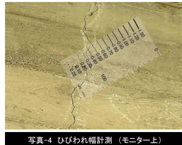
写真-4 ひびわれ幅計測 (モニター上)
