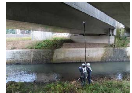
・ロボットカメラの点検イメージ
