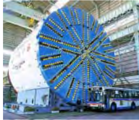
泥水式シールド機
