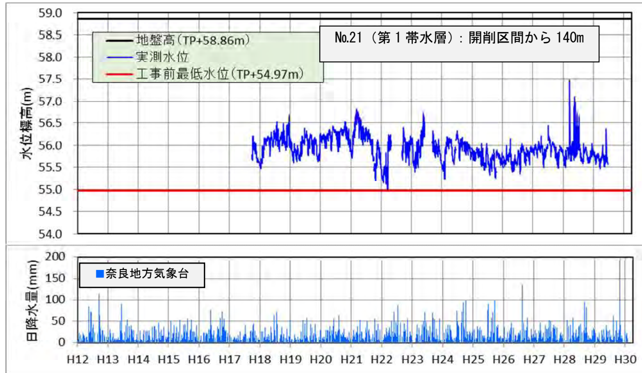
図-15 管理基準値Aの仮設定（観測孔No.21）
