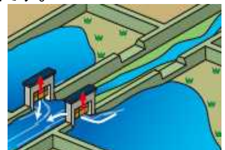
▲ 洪水後(遊水地内に溜めた水を排水)
