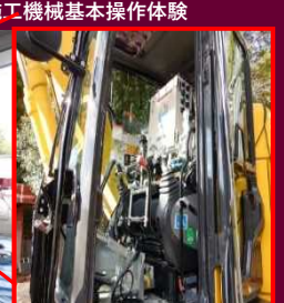
簡易遠隔操縦機器 (ロボQS)
