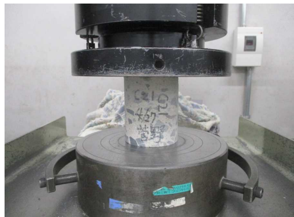
公的試験機関での圧縮強度試験
