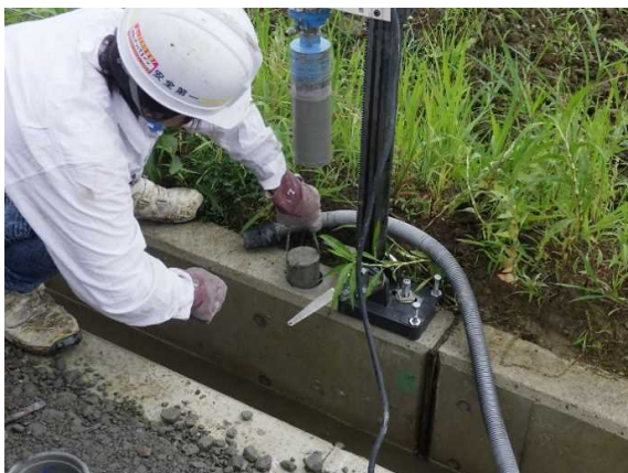
強度試験用のコアの採取
