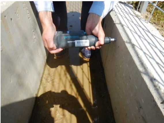
テストハンマーによる強度測定
