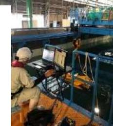
※TM: テンプレートマッチング…簡略化した構造物モデルに現地計測結果を合わせ込むこと
