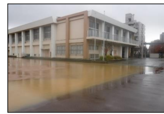
雨水流出抑制施設(校庭貯留)
