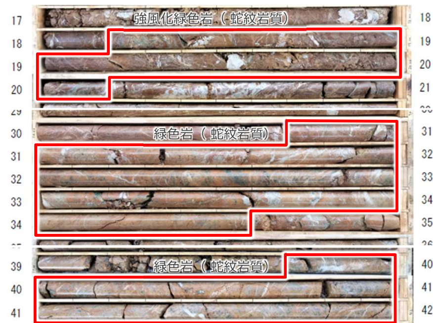
写真4 水平ボーリングのコア状況（新下半原トンネル）
