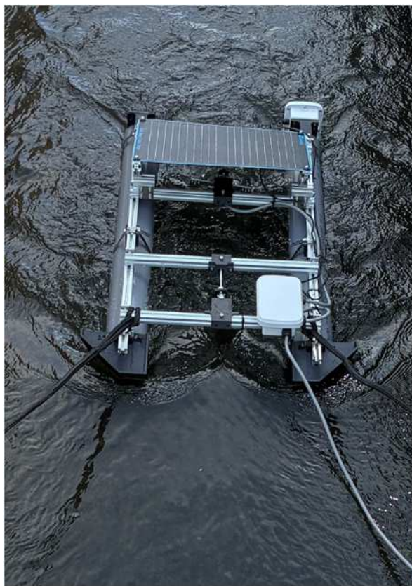
【流況観測モジュール】 発電、計測（水位・流速）、通信を行う
