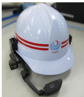
▲ヘルメットに装着したウェアラブルカメラで 現場の映像を遠隔地に共有します
