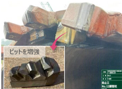
写真6 鋼管杭先端のビット
