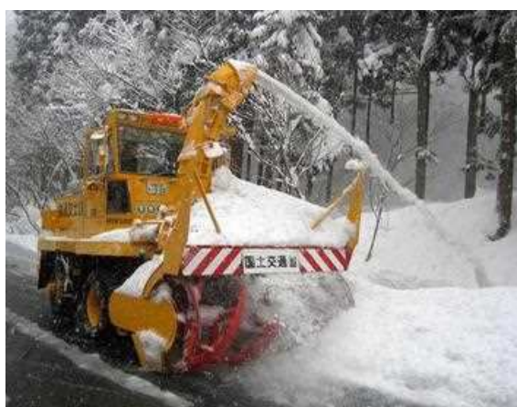
ロータリ除雪車による除雪(前方から)
