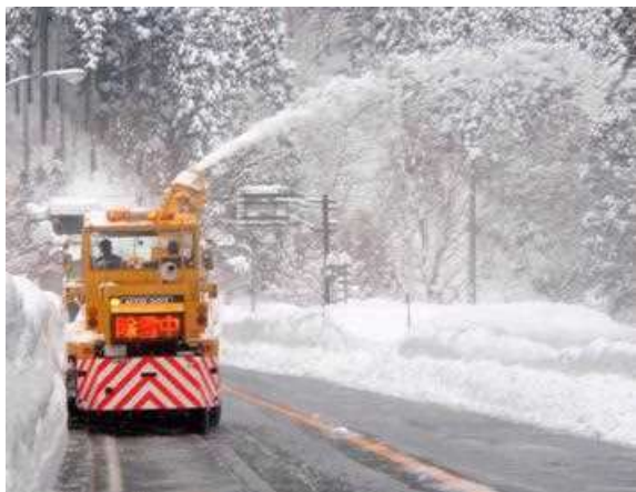
ロータリ除雪車による除雪(後方から)
