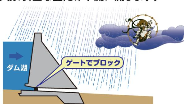
流水型ダムとは洪水調節専用のダムであり、平常時は水を貯めずに、洪水時に一時的に水をためる、下流河川の洪水被害を低減するダムのことです。
