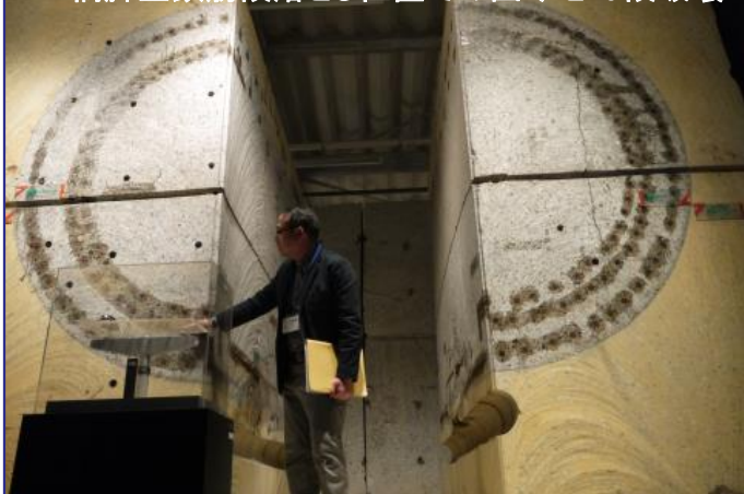
RC橋脚主鉄筋段落とし位置での曲げせん断破壊
