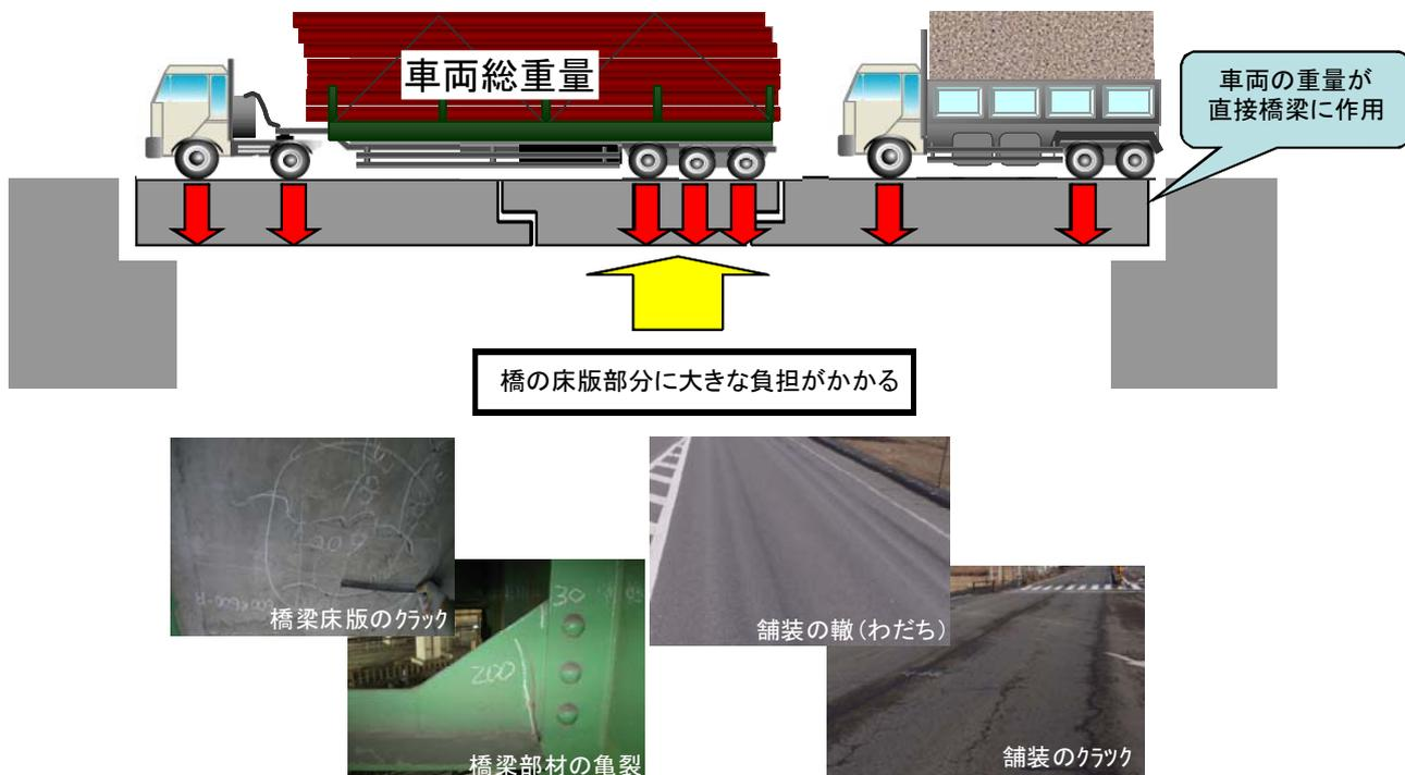
■車両の重量による道路構造物の疲労に及ぼす影響
