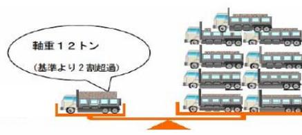
例えば、大型車両1台が軸重10トンの基準よりも2トン超過した場合、橋梁に対しては約9台分の加重が蓄積され、道路が損傷する原因になります。
