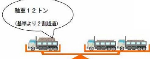
例えば、大型車両1台が軸重10トンの基準よりも2トン超過した場合、舗装に対しては約2台分の加重が蓄積され、道路が損傷する原因になります。
