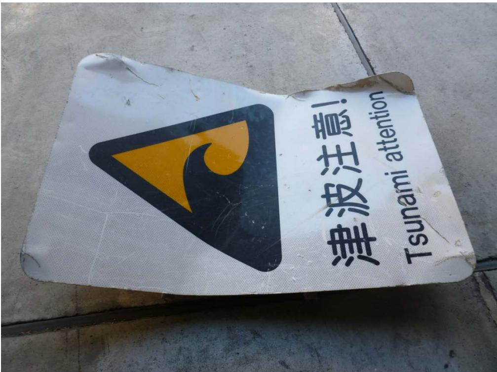
岩手県宮古市の国道45号で回収した「津波注意！」の小型標識です。津波想定浸水区域内に設置した標識ですが、津波を受けて大きく歪曲しています。
