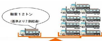
例えば、大型車両1台が軸重10トンの基準よりも2トン超過した場合、橋梁に対しては約9台分の加重が蓄積され、道路が損傷する原因になります。
