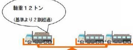
例えば、大型車両1台が軸重10トンの基準よりも2トン超過した場合、舗装に対しては約2台分の加重が蓄積され、道路が損傷する原因になります。
