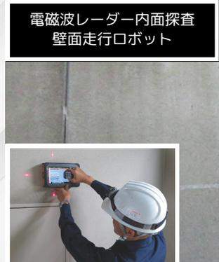
電磁波レーダー内面探査
