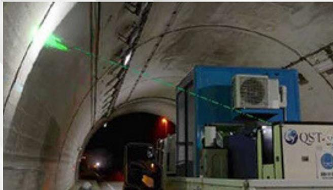
レーザー打音検査
