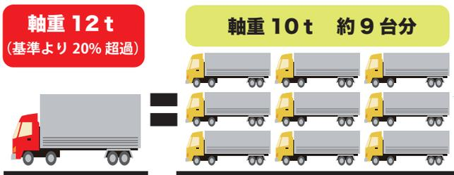
基準軸重10tを20%オーバーした車両の道路や橋への影響は、なんと法律を守った軸重10tの車両約9台分
