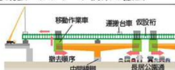
② 既設コンクリート橋梁の撤去
