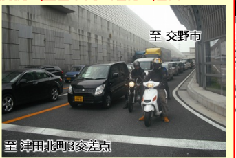
右折レーンを超過して滞留し、後続の直進車両の走行を阻害
