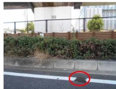
【7月20日(水)発見】 落下した鉄板 200mm × 225mm × 6mm
