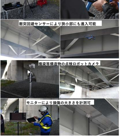
全方向衝突回避センサーを有する小型ドローン技術
