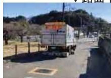
(空洞探査車による調査)
