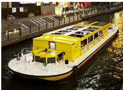
水に沈む深さを 変えられる船「ほたる」
