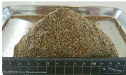
製造された再生砂
