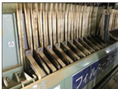
圧搾式フィルタープレスによる 建設汚泥（泥水）を発生抑制
