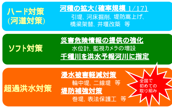
図 - 2 緊急河道対策の3本柱
