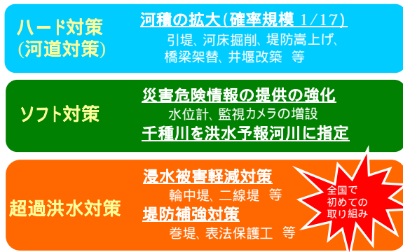
図 - 2 緊急河道対策の3本柱
