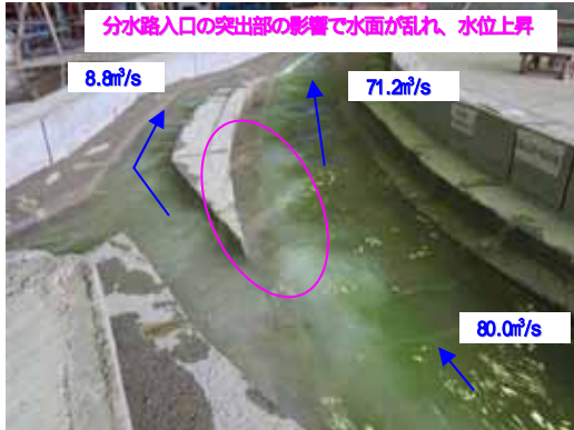
写真-2 分水路流況(CASE1: 将来河道実験、現川通水無)
