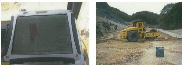
振動ローラ車載 GPS システム(モニター)      GPS システム搭載振動ローラ
