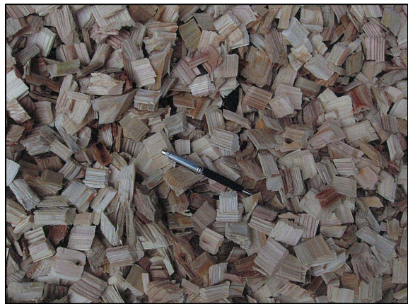
写真-3 再利用状況 (チップ化された流木)
