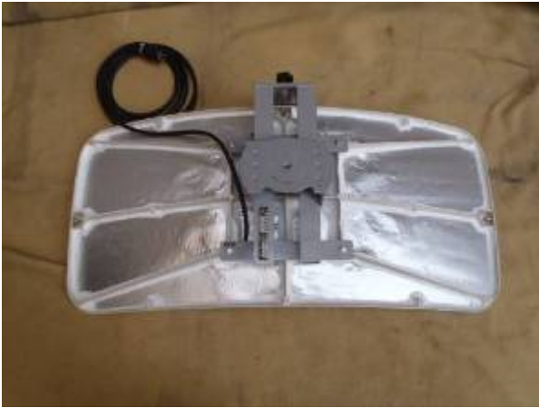
図-10 Ku-SAT (融雪ヒーター設置済み)
