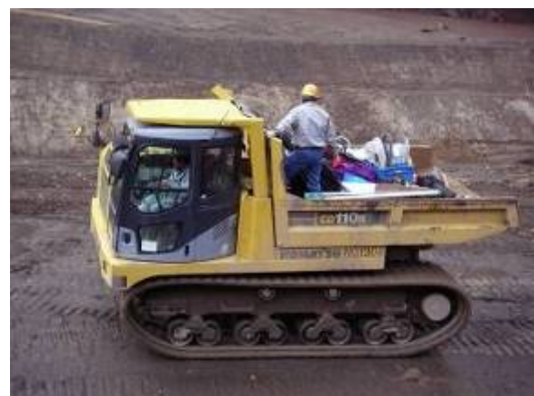
図-9 クローラダンプによる機材運搬状況
