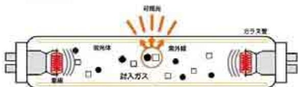
封入したガスと電子が衝突することにより光を発する
