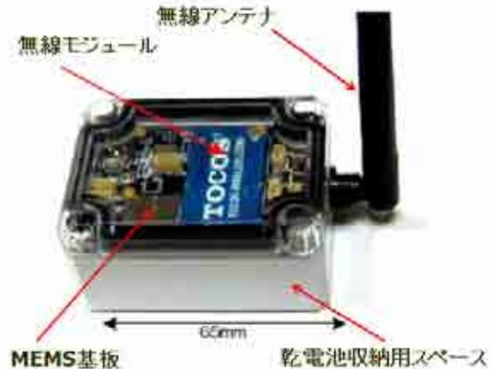
図-1 ナノセンサデバイスの概念
