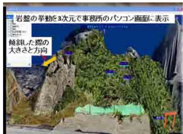
図-3 橋杭岩モニタリングシステムの実用例
