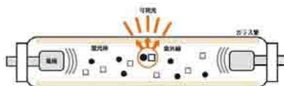
図-2 CCFLの点灯の仕組み
