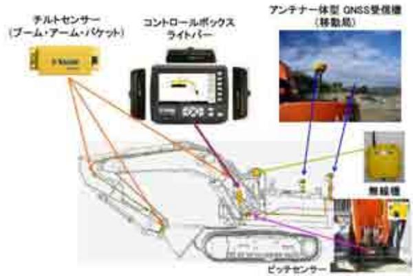
図-8 バックホウに取り付ける機器類
