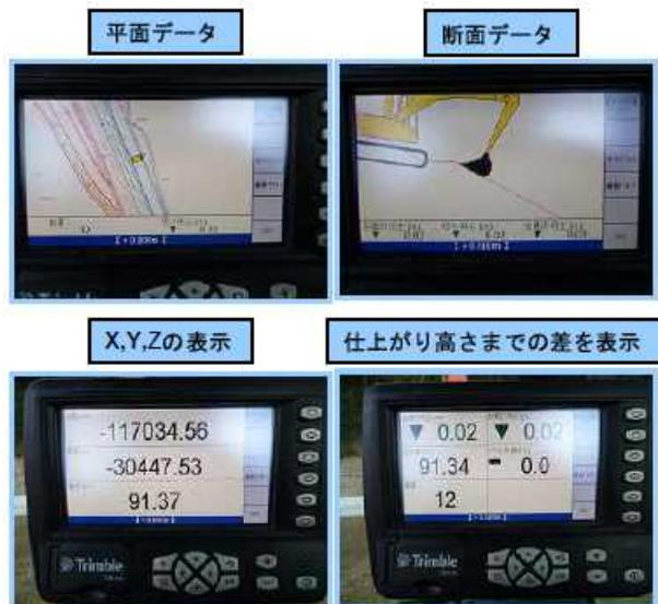
図-11 コントロールボックスからのガイダンス状況
