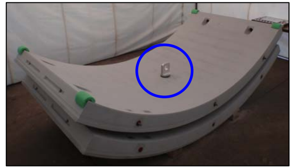
写真-2 吊金物取付状況
