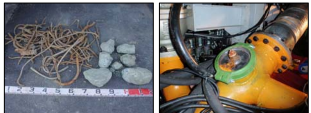
写真-5 異物回収状況および回収蓋設置状況
