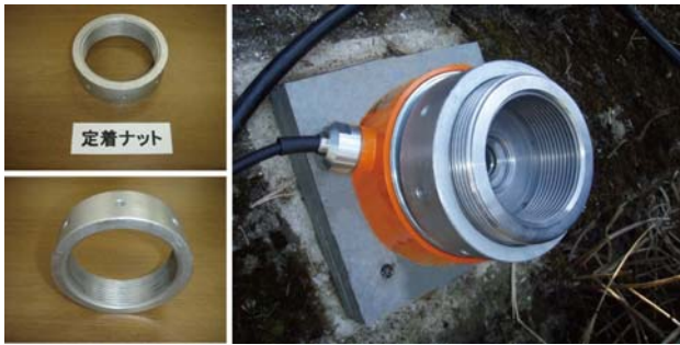
写真4 定着ナットの設置
