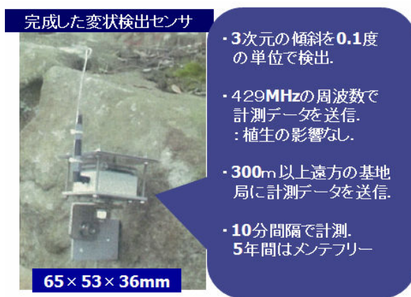
図-7 開発した無線センサデバイスの特性
