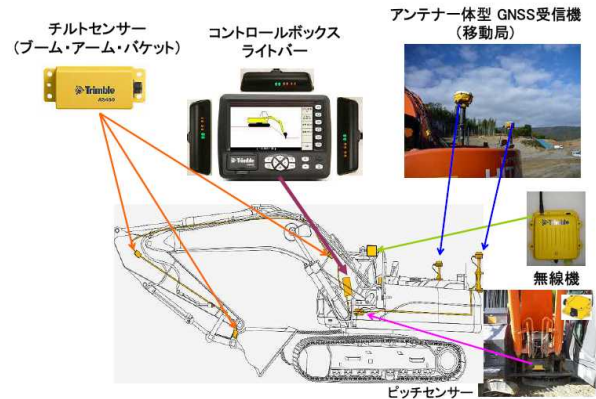
図-8 バックホウに取り付ける機器類
