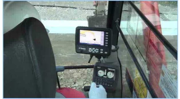
図-12 運転席からの施工確認状況
