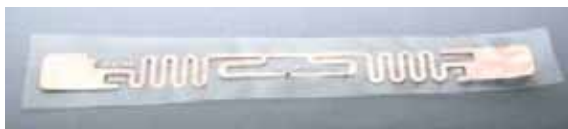
写真-3 UHF帯のICタグとアンテナ
