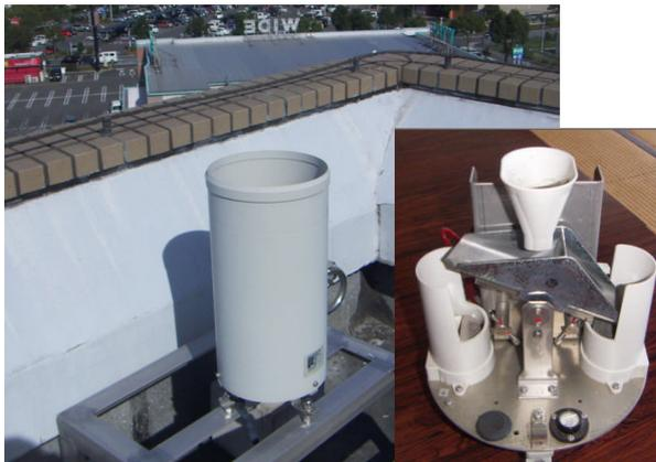
図4-4 水口局雨量計(左)と転倒ます(右)
