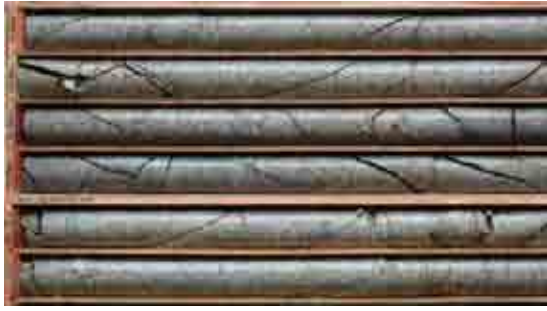
図5 口径86mmのボーリングコア
