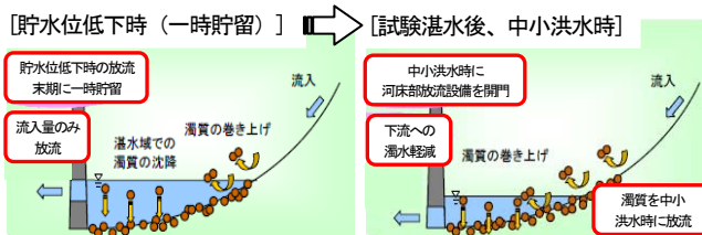
図-9 濁水の一時貯留及び出水時放流のイメージ
