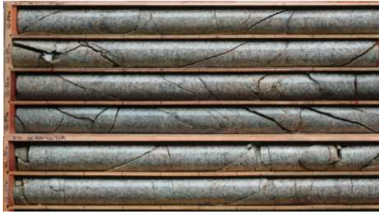
図5 口径86mmのボーリングコア
