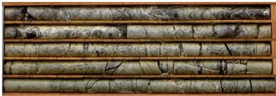
図6 口径66mmのボーリングコア
