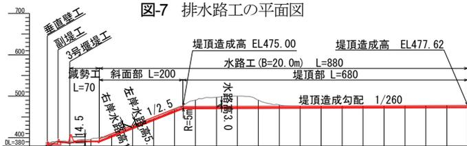
図-8 排水路工の縦断面図
