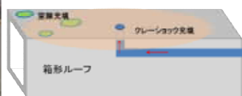
写真-2. 箱形ルーフ内のクレーショック充填状況
