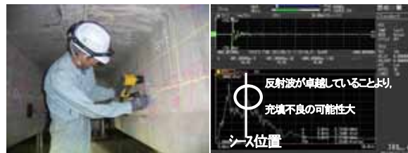
写真-3 IE法 調査状況・出力波形例
