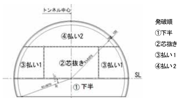
図-5 分割発破断面（4分割）
