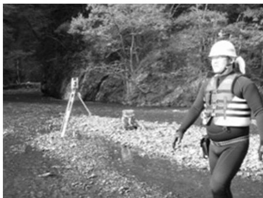
図-12 ミラー帽による測量状況
