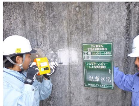
図-7 シュミットハンマーによる試験
